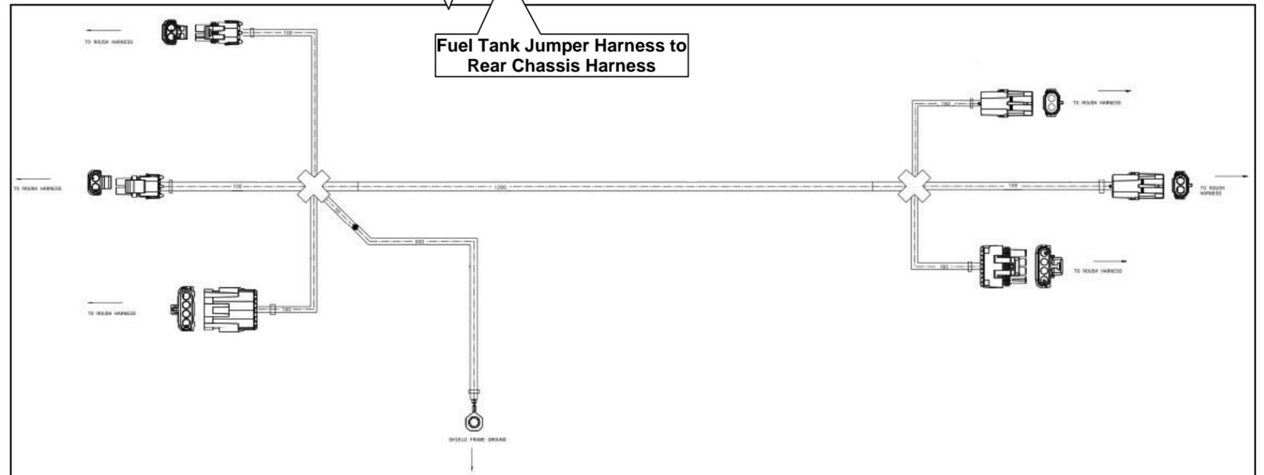
**SCHEMATIC — ROUSH WIRING HARNESS (F-53/F-59)**
